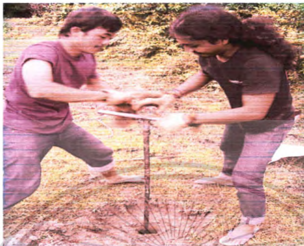
รูปที่ 3.3. ทำการเจาะสำรวจด้วยสว่านมือ (Hand Auger)
