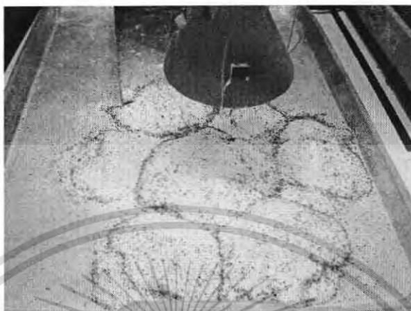
รูปที่ 4.4 การกระจายตัวของผงซักฟอกเมื่อใช้ตัวกระจายผงซักฟอกขนาดมูมยอด 60 องศา
