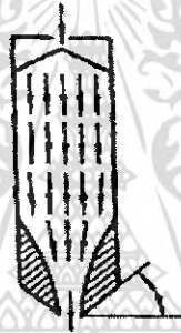
รูปที่ 2.5 ตัวอย่างลักษณะการไหลของอนุภาคแบบ Funnel Flow
