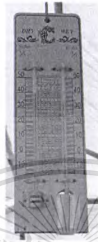
รูปที่ 3.8 เทอร์โมมิเตอร์กระเปาะแห้งกระเปาะเปียก
