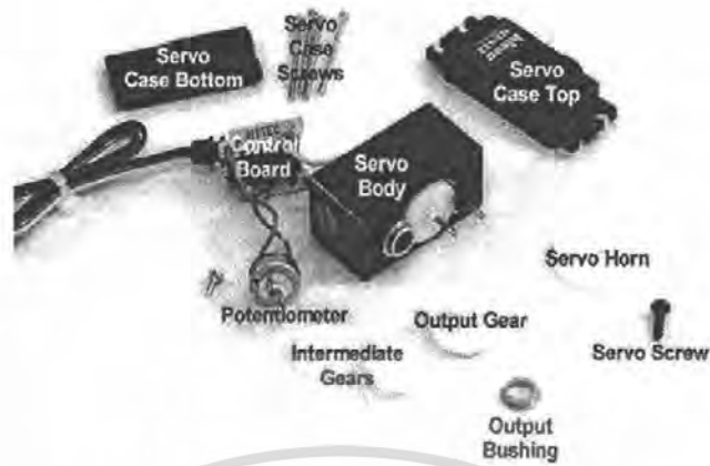
รูปที่ 2.8 แสดงส่วนประกอบของเซอร์โวมอเตอร์
