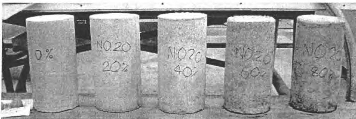
รูปที่ 3.3 แท่งคอนกรีตที่ได้จากการหล่อ
