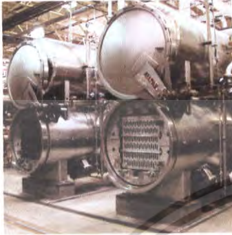
รูปที่ 2.4 หม้อฆ่าเชื้อแบบให้ความร้อนท่วมบรรจุภัณฑ์ตลอดเวลาในการฆ่าเชื้อ
