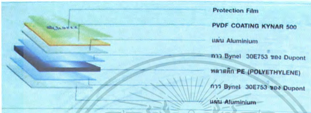
ภาพที่ 3.17 แสดงโครงสร้างของ Aluminum Composite Panel
