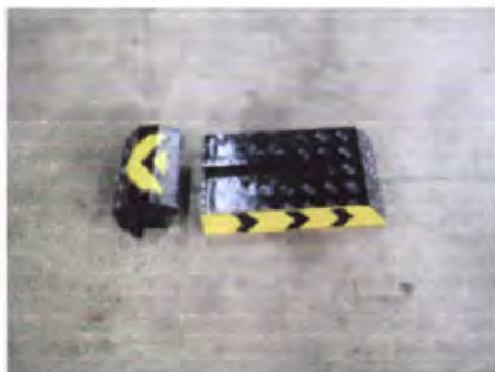
รูปที่ 4-3 ภาพฝาครอบแบตเตอรี่และฝาครอบมอเตอร์
