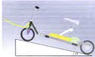
รูปที่ 2-13 ภาพแสดงรถขับเคลื่อนล้อหลังจอดนิ่งอยู่บนทางชัน
