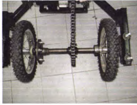
รูปที่ 5-2 ภาพประกอบมอเตอร์เข้ากับเฟลาส์ล้อหลัง
