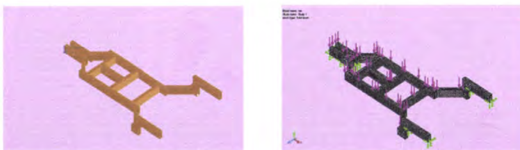
รูปที่ 3-2 ภาพแสดงการใช้โปรแกรม Solidworks 2006 สร้างรูปโครงรถขึ้นมา
