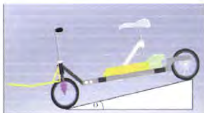
รูปที่ 3-13 ภาพแสดงรถจักรยานเคลื่อนล้อหลังสามารถทรงตัวได้อยู่ได้พอดี บนทางชัน
