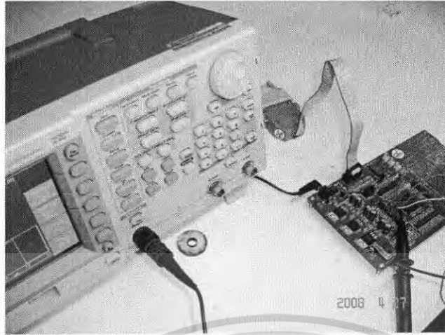
รูปที่ 3.15 การต่อเครื่องกำเนิดสัญญาณเข้ากับบอร์ด FPGA
