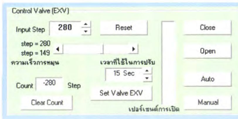
รูปที่ 5.4 แสดงโปรแกรมจะทำการปรับตั้งตำแหน่งวาล์ว EXV ในตอนเริ่มต้น
