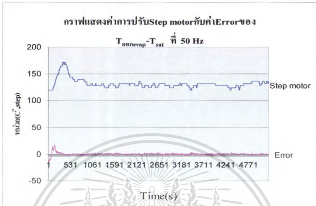
กราฟที่ 6.9 แสดง ค่าการปรับ Step motor กับค่า Error ของ T_{\text{boilvapor}} - T_{\text{sat}} ที่ 50 Hz
