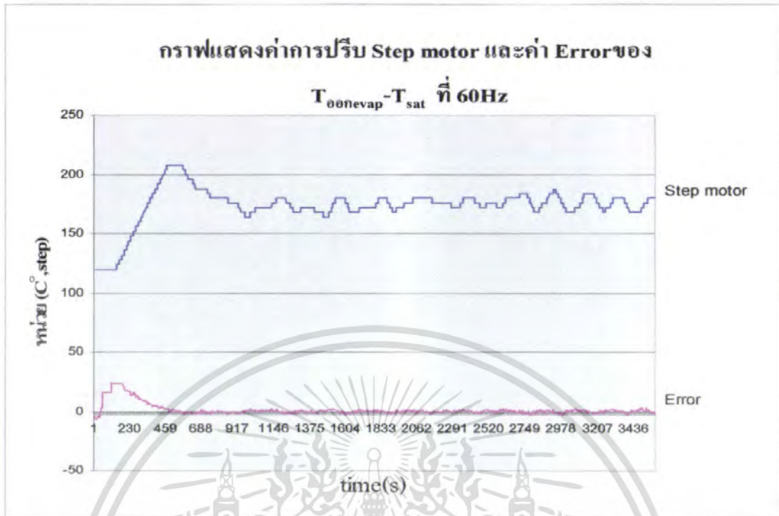
กราฟที่ 6.12 แสดง ค่าการปรับ Step motor กับค่า Error ของ T_{\text{boonevap}} - T_{\text{sat}} ที่ 60 Hz
