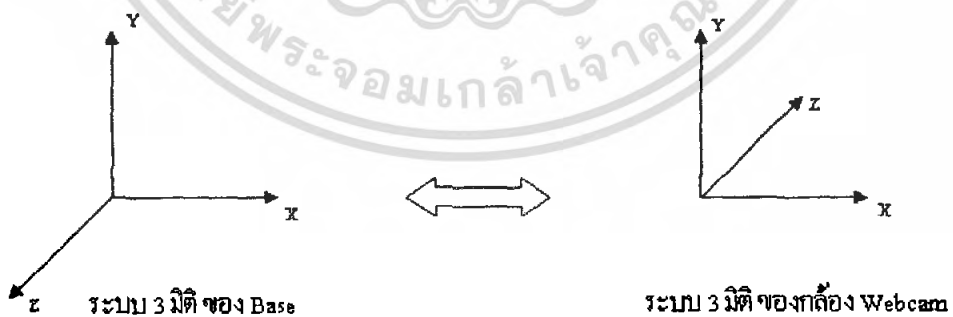
รูปที่ 3.3 การแสดงแกนของ Base และกล้อง
