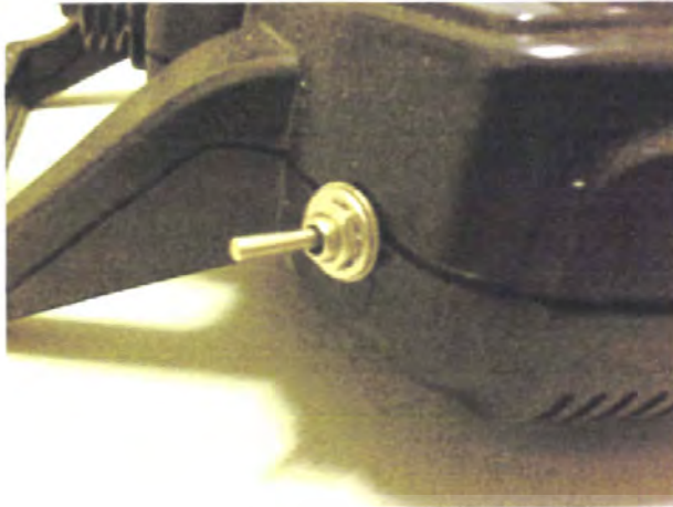
รูปที่ 3.16 แสดงสวิตซ์ในการปรับ Auto-Manual
