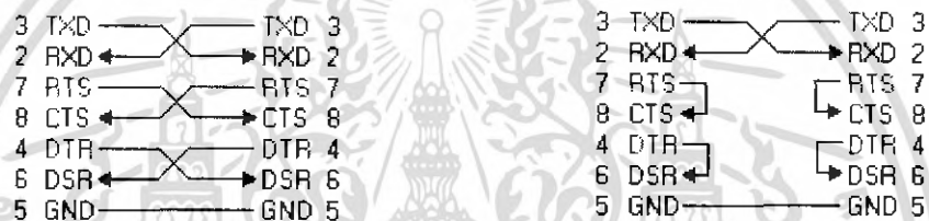
ภาพที่ 2.5 การเชื่อมต่ออุปกรณ์ภายนอกผ่าน DB9 แบบ Null modem
