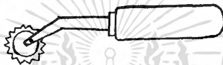
ภาพที่ 44 แสดงลูกกลิ้งชนิดฟันแหลมยาว
