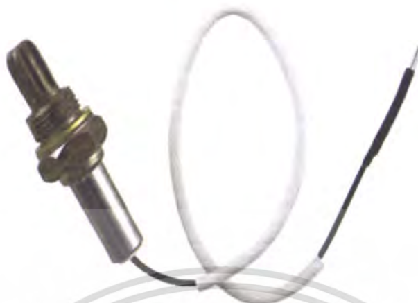
รูปที่ 2.16 ตัวตรวจจับปริมาณออกซิเจนชนิด Narrowband (NB)
