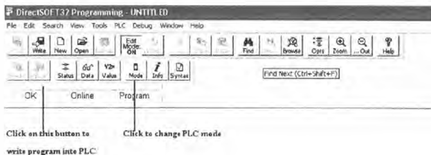
รูปที่ 2.15 แสดงไอคอนการติดต่อกับ PLC
