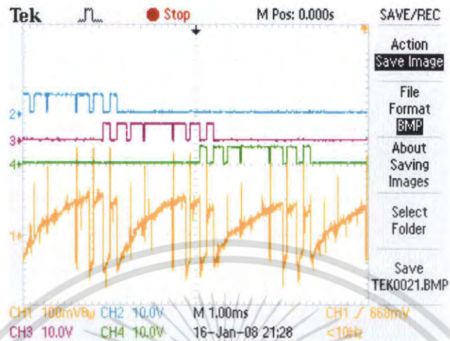
รูปที่ 4.23 สัญญาณกระแส Sinusoidal mini step
