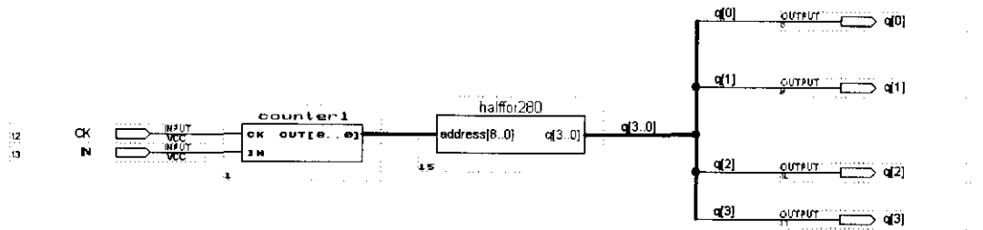
รูปที่ 4.6 ทดสอบสัญญาณ Half step แบบ Forward
