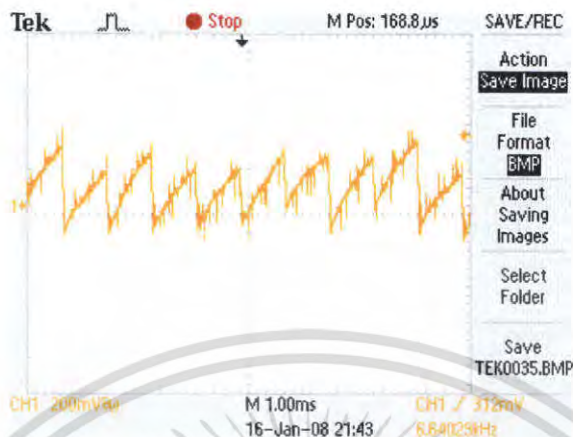
รูปที่ 4.25 สัญญาณกระแสเมื่อสลิปที่โหมด Half step
