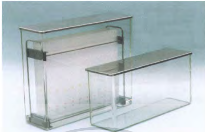
รูปที่ 2.6 แผ่นเฟลต (plate) และทีแอลซีแทงก์ (TLC tank)
