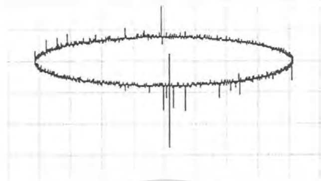
รูปที่ 5.50 PD บนรูปคลื่นอิลิปส์ ที่แรงดัน 4.63 kV
