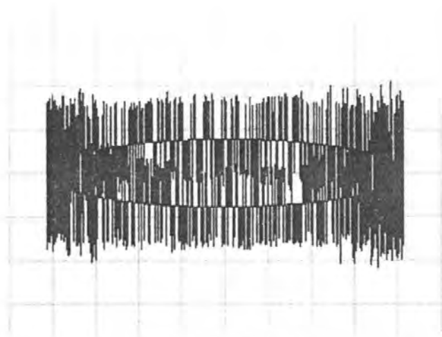
รูปที่ 5.60 PD บนรูปคลื่นอิลิปส์ ที่แรงดัน 2.47 kV ค่าดีสชาร์จ 1.54 pC
