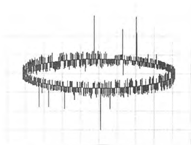
รูปที่ 5.40 PD บนรูปคลื่นอิลิปส์ ที่แรงดัน 3.00 kV
