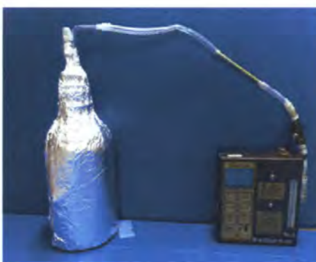
รูปที่ 3.5 อุปกรณ์ที่ใช้ในการเก็บไอระเหยของเบนซิน
