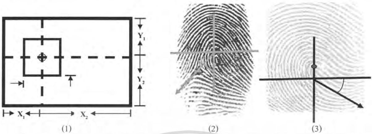
รูปที่ 5.2 รูปแสดงการแบ่งพื้นที่ค้นหาจุดอ้างอิง (1) รูปแสดงการคัดแยกปลายนิ้วมือ โดยใช้มุม (2, 3)
