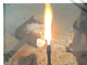
ภาพที่ 11 ลนแท่งแก๊วขนาดใหญ่แล้วต่อกับก้านที่ทำไว้ หนีบด้วยคีมแบนให้มีรูปร่างเหมือนใบใช้คีมเล็กบีบ ตรงบริเวณใบให้เป็นรอยของใบไม้ลนด้วยไฟทั้งผลอีกครั้ง ที่มา: กลุ่มหัตถกรรมแก๊วถัก (4550)
