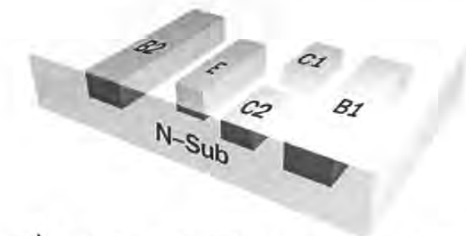
รูปที่ 3.1 ด้านตัดขวางโครงสร้างของเมกนีโททรานซิสเตอร์ห้าขา
