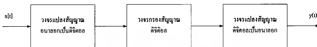
รูปที่ 2.18 แผนภาพของวงจรกรองความถี่สัญญาณดิจิทัล
