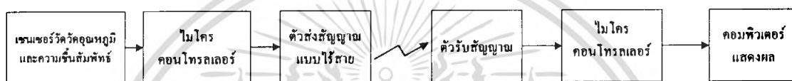
รูปที่ 2.1 บล็อกไดอะแกรมของระบบติดตามผลและส่งข้อมูลทางอุดมศึกษา
