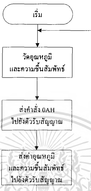
รูปที่ 3.11 แสดงโฟลว์ชาร์ตการทำงานของชุดสถานีวัดอุณหภูมิและความชื้นสัมพัทธ์ที่ 1
