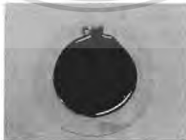
รูปที่ 4.3 สิ่งที่เหลือจากการกลั่นกลีเซอรอลด้วยเครื่องกลั่นแบบลดความดัน
