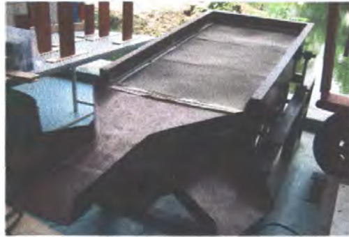
รูปที่ 3.1 เครื่องร่อนแยกขนาด 4 ระดับ (กรมป่าไม้)
