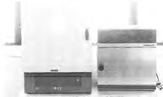
รูปที่ 3.1 แสดงเตาอบอุณหภูมิสูง 1050 °C และ 200 °C ตามลำดับ
