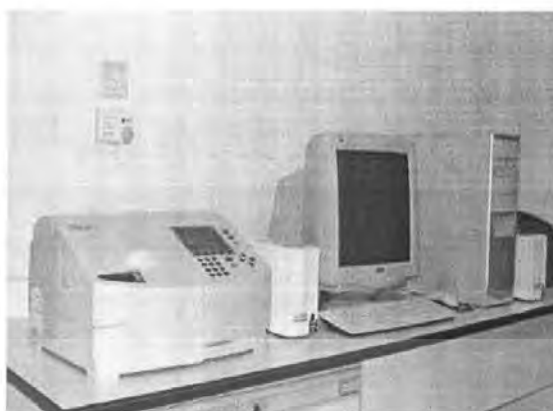
รูปที่ 3.3 แสดงเครื่อง UV-VIS แบบดับเบิลเบีมสเปกโตรโฟโตมิเตอร์ยี่ห้อ Thermo electron corporation รุ่น Helions \alpha
