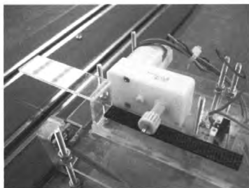
รูปที่3.11 มอเตอร์ขับเคลื่อนชุดเฟืองและแกนเลื่อน
