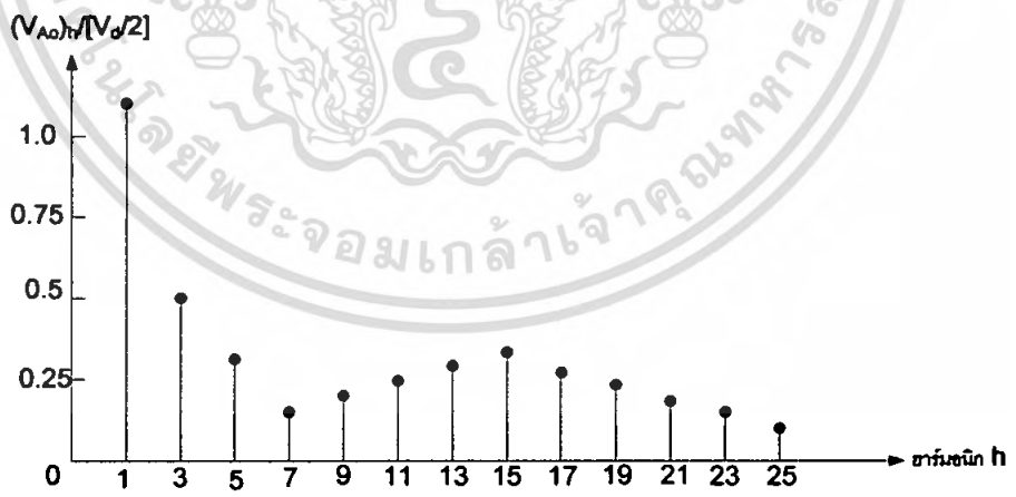
ภาพที่ 2.14 แสดงสเปกตรัมของรูปคลื่นPWMแบบโอเวอร์มอดูเลต เมื่อ ma=1.25 , mf = 15
