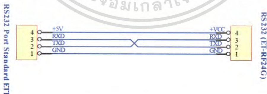
รูปที่ 2.30 แสดงการต่อสายสัญญาณ RS232 เพื่อใช้แหล่งจ่ายไฟจากบอร์ดไมโครฯ ของ ETT
