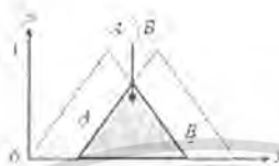
รูปที่ 2.24 Intersection ของฟังก์ชันเซต A และ B
