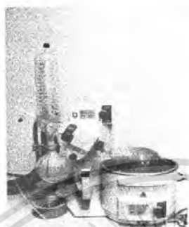
ภาพผนวกที่ 4 แสดงการระเหยด้วยระบบสุญญากาศ
