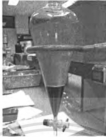
รูปที่ 3-3 แสดงการแยกชั้นระหว่างไบโอดีเซล(ชั้นบน)และกลีเซอรอล(ชั้นล่าง)
