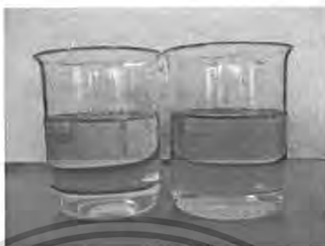
รูปที่ 3-8 ไบโอดีเซลที่สังเคราะห์จากน้ำมันที่ให้ความร้อนด้วยพลังงานแสงอาทิตย์ (ซ้าย) และ ไบโอดีเซลที่สังเคราะห์จากน้ำมันที่ให้ความร้อนแผ่นให้ความร้อน(ขวา)
