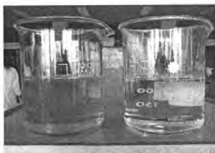
รูปที่ 3-5 แสดงลักษณะน้ำมันก่อน (ซ้าย) และหลัง(ขวา) ผ่านปฏิกิริยาทรานส์เอสเทอร์ริฟิเคชัน
