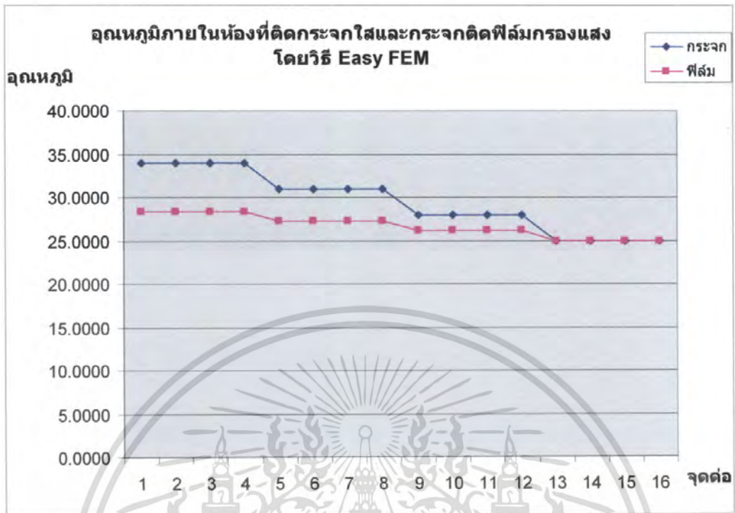
รูปที่ 3.35 แสดงอุณหภูมิภายในห้องที่ติดกระจกใสและกระจกติดฟิล์มกรองแสงโดยใช้โปรแกรมสำเร็จรูป Easy FEM
