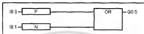
รูปที่ 2.3 ตัวอย่างการ โปรแกรมแบบฟังก์ชันบล็อกไดอะแกรม
