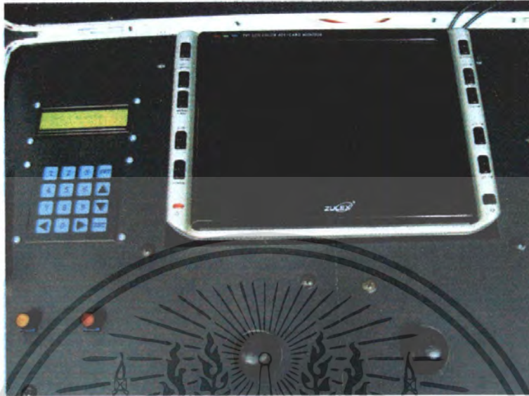
รูปที่ 3.10 แสดงอุปกรณ์บังคับและการแสดงผล
