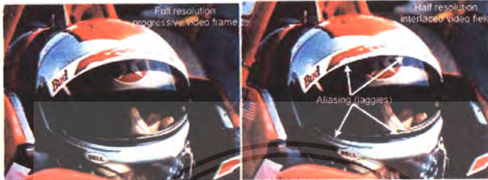
รูปที่ 2.8 ระบบการ โปรเกรสซีฟสแกน
