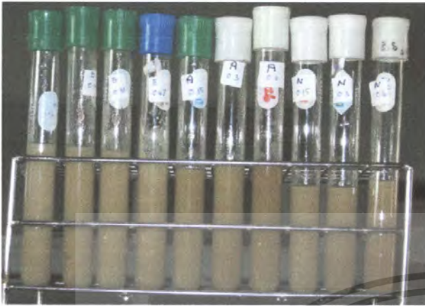
ภาพที่ 8 การไฮโดรไลซ์หอยลายด้วยผงทำให้เนื้อนุ่ม เอนไซม์อัลคาเลส และนิวเทรส(จากซ้าไป ขวา)ที่ 3 ชั่วโมง ที่อุณหภูมิ 50 °C
