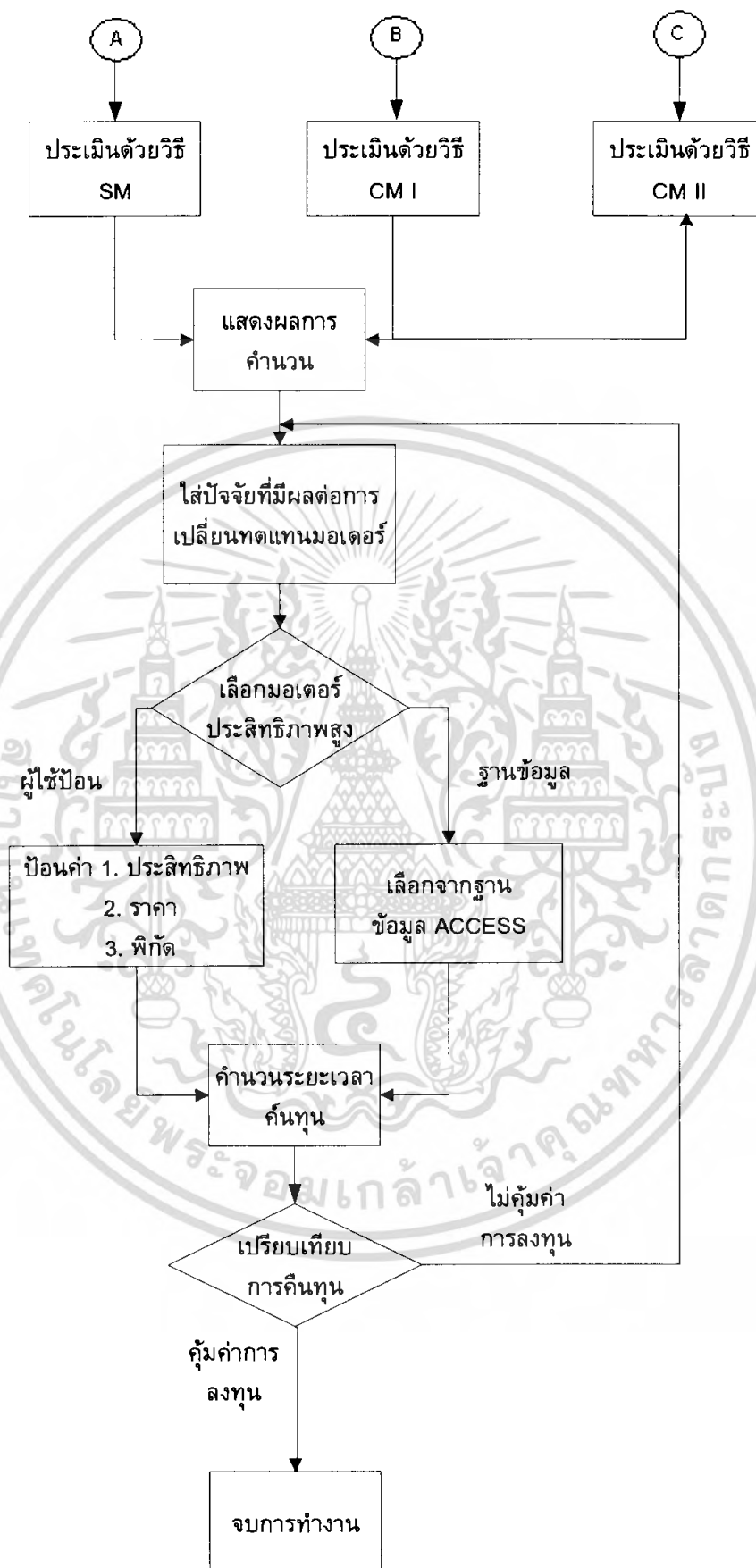
ภาพที่ 5.1 ขั้นตอนการทำงานของโปรแกรมเปลี่ยนทดแทนมอเตอร์ (Flow chart)
