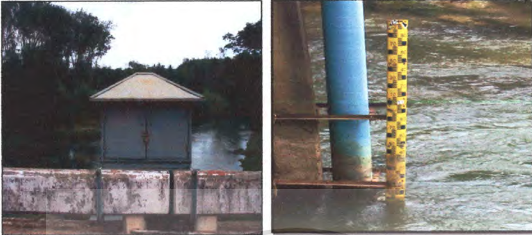
ภาพที่ 2 แสดงสถานีตรวจวัดน้ำฝนและวัดระดับน้ำ
