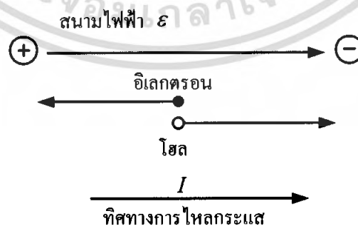
รูปที่ 2.12 ความเร็วของการเคลื่อนที่ของอนุภาค จะแปรผันตรงกันสนามไฟฟ้า
