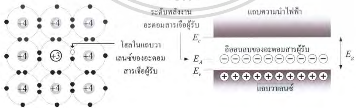
รูปที่ 2.11 พันธะเคมีและแผนภาพระดับพลังงานสารกึ่งตัวนำแบบเอ็กซีทรินซิกแบบพี
