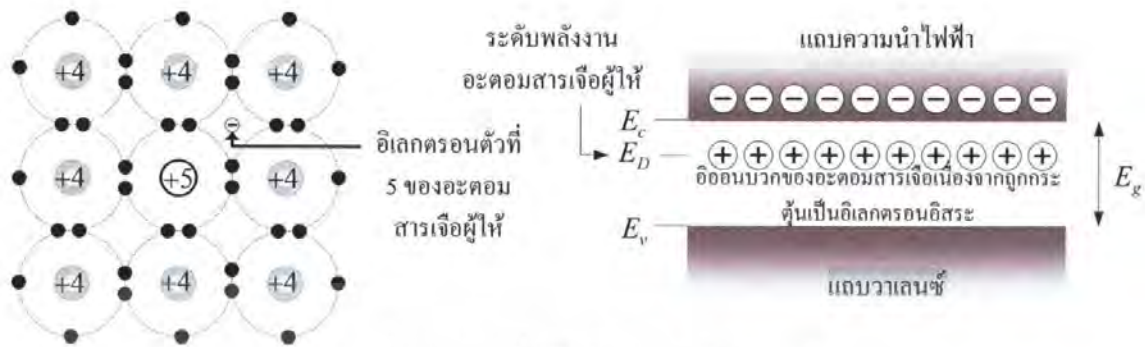
รูปที่ 2.10 สารกึ่งตัวนำเอ็กทรินซิกแบบเอ็น
