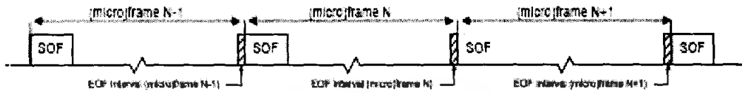
รูปที่ 2.18 เฟรมของข้อมูลในระบบ USB
