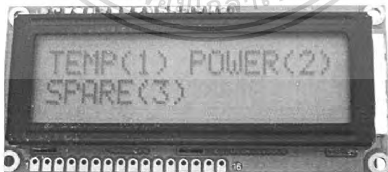
รูปที่ 4.5 จอแอลซีดีจะแสดงข้อความให้เลือกส่วนเก็บบันทึกข้อมูล
