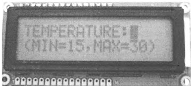
รูปที่ 4.6 จอแอลซีดีแสดงข้อความส่วนเก็บข้อมูลสัญญาณเปลี่ยนอุณหภูมิ สามารถบันทึกได้ตั้งแต่อุณหภูมิ 15-30 องศาเซลเซียส
