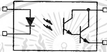
(ข) ออปโตคัปเปิลอร์แบบใช้เอาต์พุตเป็นไดโอดคิงคินทรานซิสเตอร์
