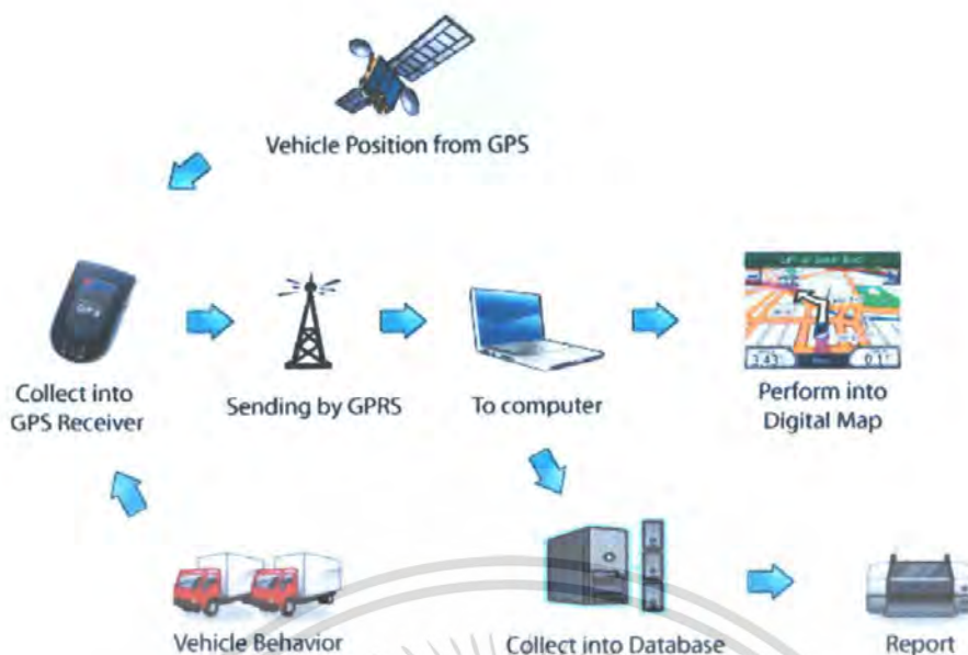
ภาพที่ 2.5 การทำงานของระบบติดตามยานพาหนะด้วยระบบจีพีเอส
