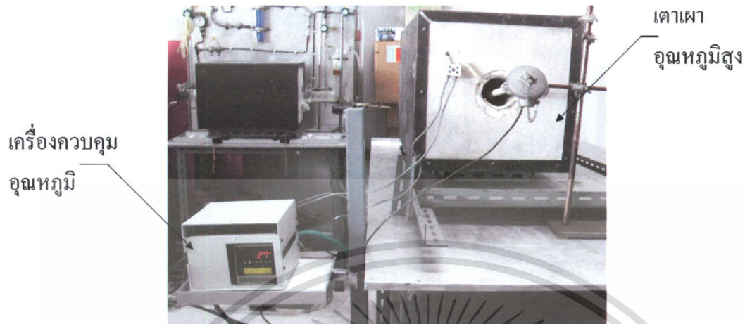
รูปที่ 3.3 แสดงเตาเผาอุณหภูมิสูงที่ใช้ในการเผาสารตัวอย่างที่อุณหภูมิ 1200 องศาเซลเซียส พร้อมด้วยเครื่องควบคุมอุณหภูมิ
