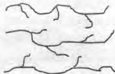
รูปที่ 2.4 แสดงรูปแบบการจัดโครงสร้างโมเลกุลของเทอร์โมพลาสติก
