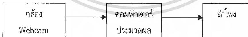
รูปที่ 3.1 แผนผังการทำงาน ของระบบตรวจจับผลากกระป๋องด้วยโปรแกรม MATLAB
