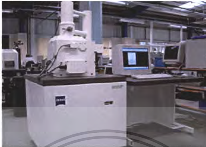
รูปที่ 3.9 กล้องจุลทรรศน์อิเล็กตรอนแบบส่องกราด ผลิตโดยบริษัท LEO รุ่น LEO 1455 VP[1]
