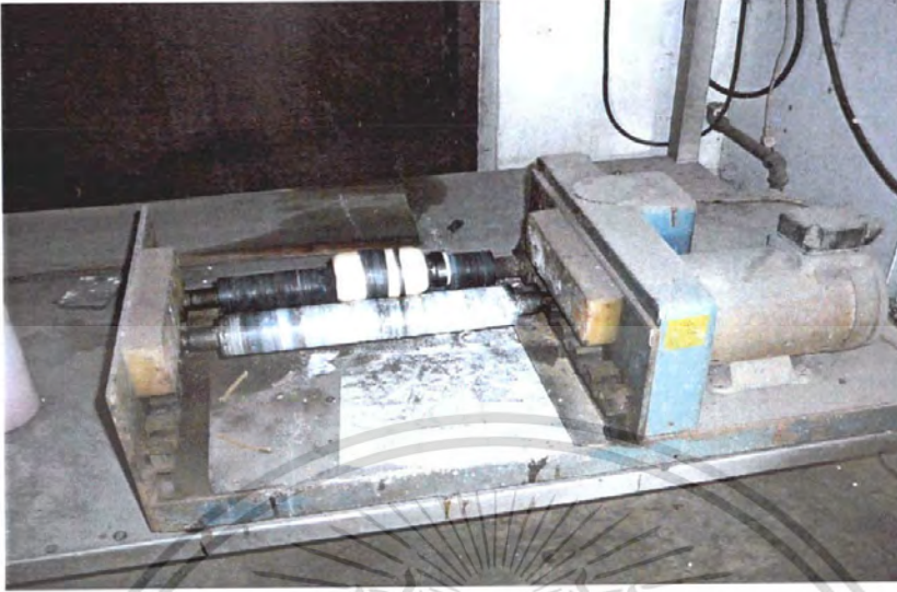
รูปที่ 3.1 การบดขยี้ด้วยเครื่องบดขยี้ (Ball-milling)
