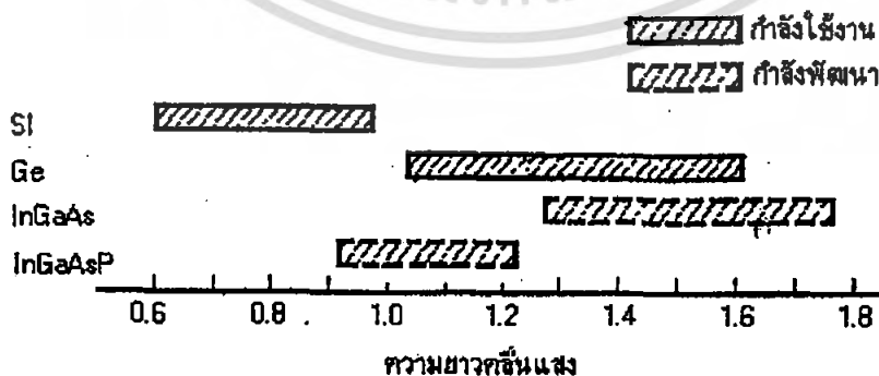
รูปที่ 2.32 แสดงความยาวคลื่นในการรับแสงของอุปกรณ์รับแสงแต่ละชนิด
