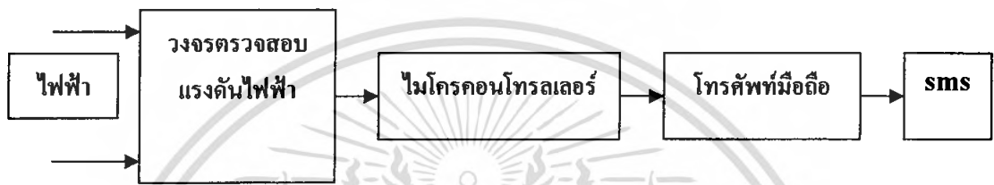
รูปที่ 3.1 บล็อกไดอะแกรมของเครื่องส่ง SMS
