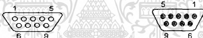
รูปที่ 2.3 คอนเน็กเตอร์อนุกรม 9 ขา หรือแบบ DB-9 (ตัวผู้กับตัวเมีย)
